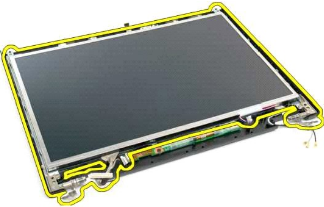
7. 將 LCD 顯示板從顯示幕組件中卸下。
