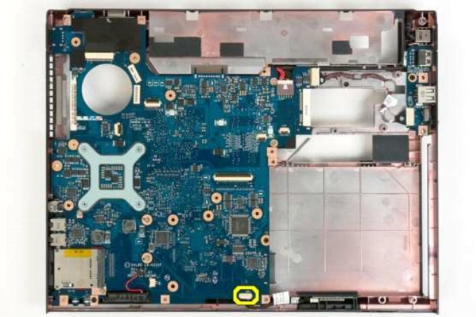
19. 從主機板拔下 USB 板資料纜線。
